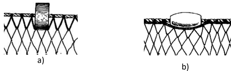
Figura 2. 18 Flotadores utilizados en las redes de enmalle; a) Cilíndricos , b) Ovoides
