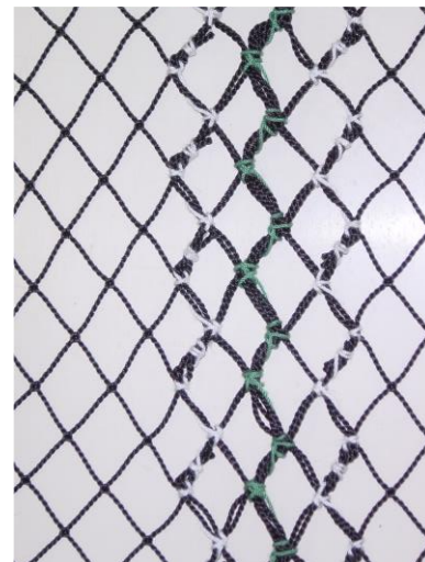
Figura 2.34. Unión vertical en paño sin nudo (nótese el traslape de media malla en cada borde de unión)
